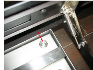
Der maximale Füllstand ist erreicht, wenn Bio-Ethanol durch die Schlitz(e) (siehe Pfeil) in die Reflektorwölbung läuft.
